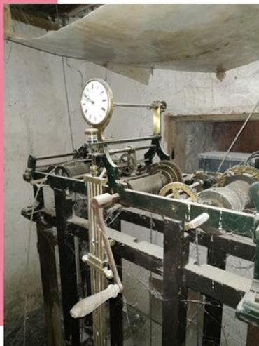
Si l'on oublie les toiles d'araignées et la poussière accumulées avec le temps, le mécanisme est dans un état remarquable. La mécanique est fonctionnelle, même pas corrodée. La boiserie est elle aussi dans un parfait état de conservation ! Quant au pendule, il est d'une taille imposante.
